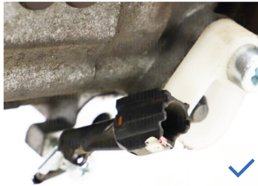
El conector no está dañado
