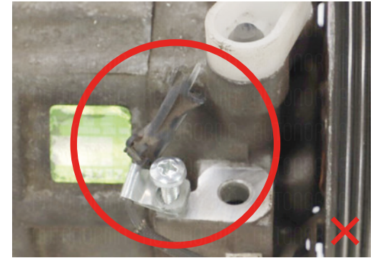
El conector falta o está dañado
