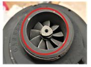
Suministro insuficiente de aceite al rotor del turbocompresor
