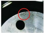
Las impurezas internas en el inyector Las impurezas en el inyector se deben a una limpieza deficiente del sistema de combustible (tuberías de combustible, filtro, raíl y depósito).
